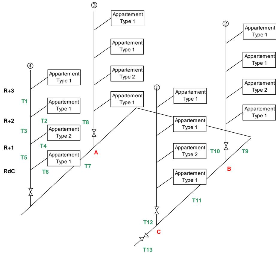
Calcul de simultanéité de  $\frac{0.8}{\sqrt{x-1}}$  pour le calcul des débits des appareils
